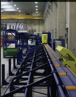
De automatische knipstraatinstallatie van Schilt Engineering BV - type Flexbar 150 A. (foto's PDC)
