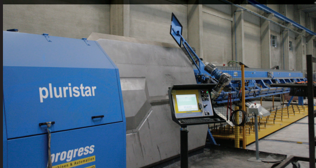
De nieuwe Pluristar 16 richt/beugelmachine - met een lengte van 30 meter - van Progress.
