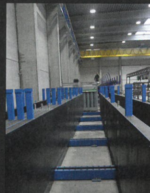
Bijkomende batterijbekisting (Cometal) met een lengte van 12 meter.
